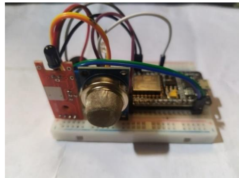
Gambar 9. Pengujian Sensor MQ-2
