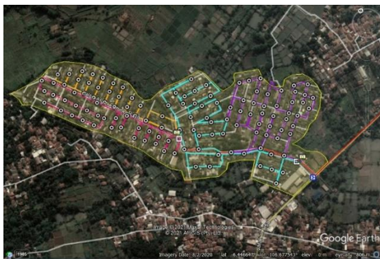
Gambar 3. Contoh Perencanaan Penjaluran FTTH via Google Earth
