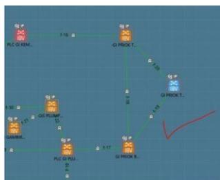
**Gambar 19. Koneksi pada NMS SDH setelah Recovery**
