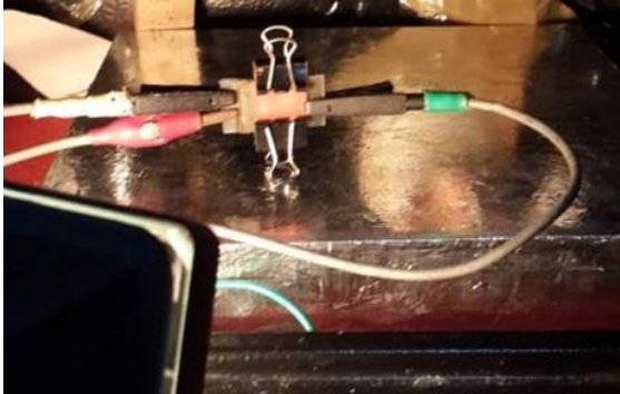
Gambar 4. Proses Pencahayaan Saat Pengukuran Arus dan Tegangan Open Circuit .
