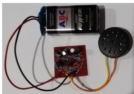
Figure 4. Assembled mini siren kit
