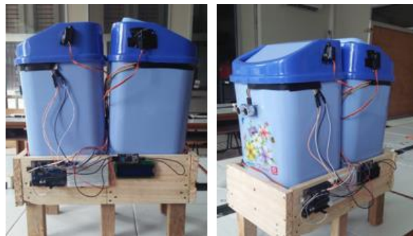
Gambar 8. Model Pendeteksi Volume Sampah Berbasis Arduino
