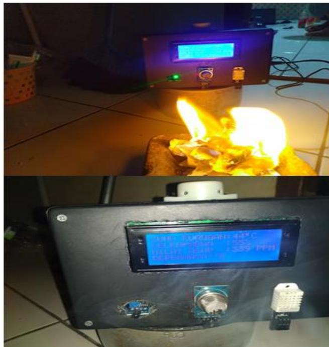
Gambar 6. Uji Coba Validasi Alat
