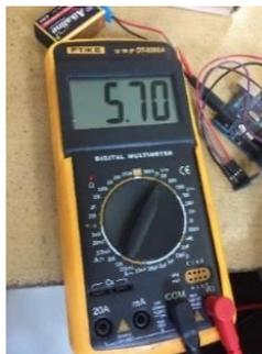
Gambar 8 Pengujian Tegangan pada Arduino Atmega 328
