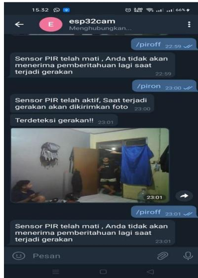
Gambar 5. Mendeteksi Objek Manusia Pada Jarak 4 Meter
