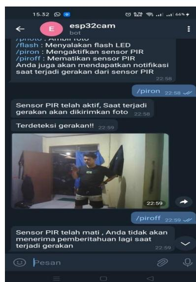
Gambar 4. Mendeteksi Objek Manusia Pada Jarak 2 Meter
