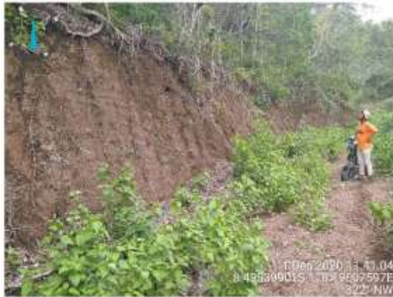
Gambar 17. Peta singkapan batupasir yang bergradasi menjadi tanah tebal >1 meter (tanah residual)
