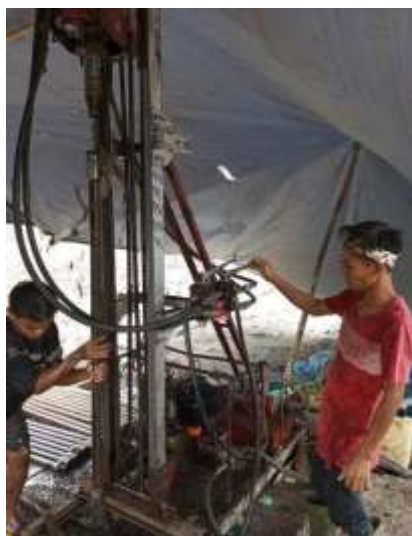
Gambar 6. Pengeboran menggunakan mesin J-Cro 175 dengan metode Openhole
