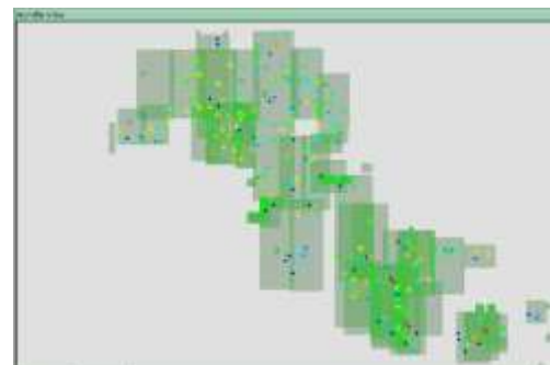
Gambar 4.3 Sebaran titik hasil optimasi GCP (biru tua tanpa arah vektor merupakan titik unused)
