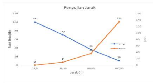
Gambar 7 Hubungan Jarak dengan Keberhasilan Pengiriman Data pada Xbee.
